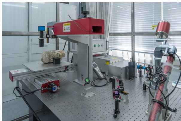
图 1 文物激光清洗全链路实验平台示意图
